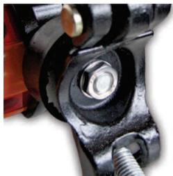
Desserrer les deux écrous de la fixation.
