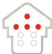
Si le récepteur est légèrement en-dessous du faisceau laser, les diodes supérieures du segment „VERS LE HAUT“ clignotent.
